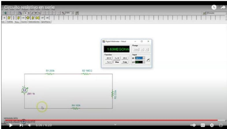
Figura 7. Captura de pantalla resolución ejercicio en video “Circuito resistivo en serie”, midiendo el parámetro resistivo en TINA-TI.
