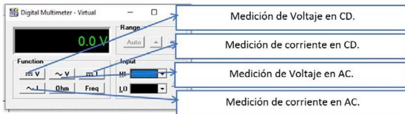
Figura 8. Opciones de medición del multímetro virtual.
